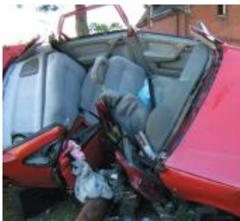
Boční náraz s typickým klínovitým defektem
