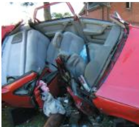
Boční náraz s typickým klínovitým defektem
